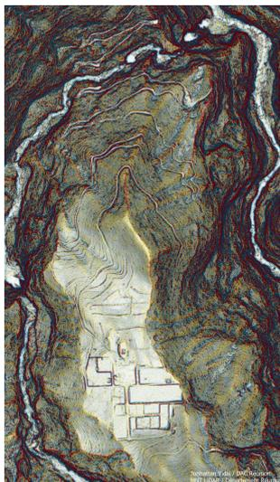
Relevé LiDAR, technique de relevé au laser qui permet, entre autres, de révéler les vestiges sous une végétation dense.
